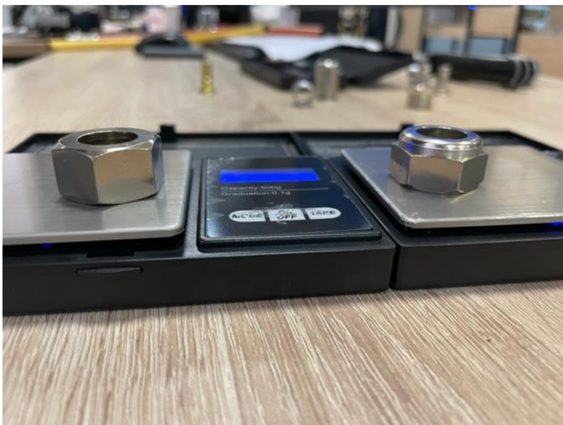
*Гайка. Слева тм N , Справа тм Монофлекс Nord Stream (специальная конфигурация. Позволяющая более плотно прилегать при монтаже шланга, что делает соединение более надежным)
