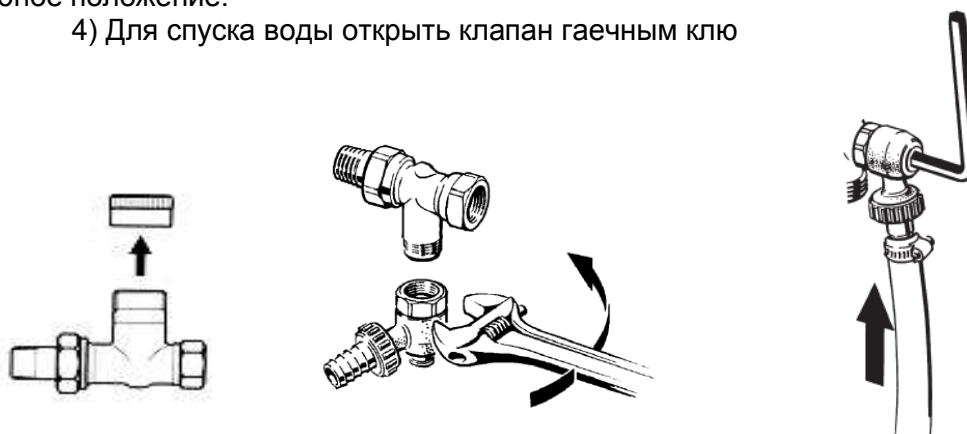
Рис. 3. Монтаж спускного крана.
